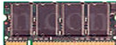
200 pin DDR SODIMM
