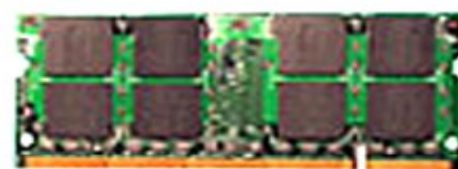
200 pin DDR-2 SODIMM
